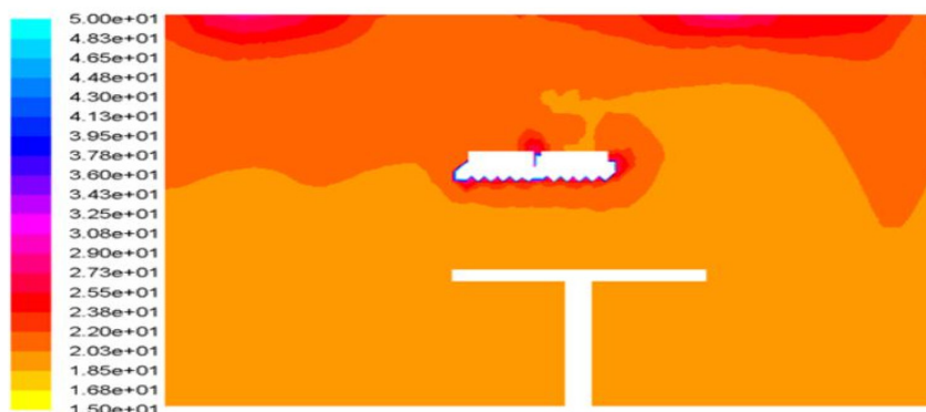
Figura 42 - Campo de temperaturas no plano A.
